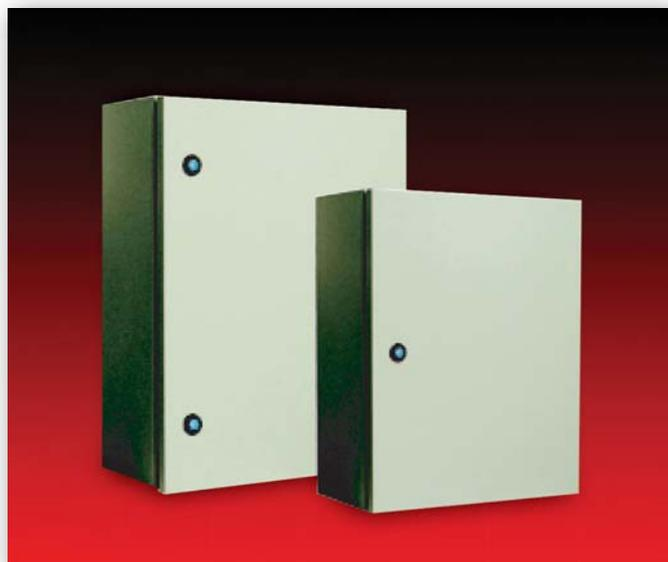
Serie completa di contenitori in metallo, di costruzione solida e robusta, con grado di protezione IP56 per resistenza alla polvere e all'acqua. Il ciclo di costruzione comprende un trattamento di fosfatazione e passivazione, seguito da una verniciatura a polveri epossidiche che fornisce al prodotto una eccezionale resistenza agli agenti atmosferici.
