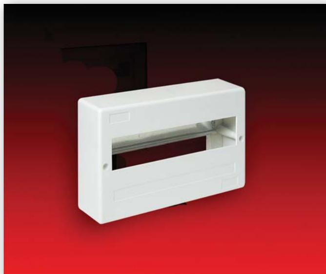
La serie Pegasus di calotte per la distribuzione di energia, sono una soluzione pratica e compatta per la realizzazione di quadri elettrici per uso domestico, fino a 63A, in combinazioni da 12 a 18 moduli, in un'unica fila. Sono costruite in materiali termoplastico autoestinguente, con prova Glow-wire fino a 650°C per 30sec, nel colore bianco RAL9016.
